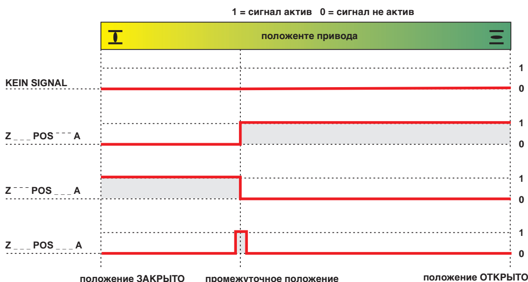
рис. P8: сигналы промежуточных положений
